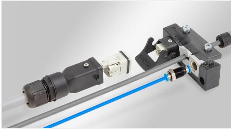
Il sistema di interfaccia modulare (MIS) è un ingresso cavi divisibile per cavi con e senza connettori in combinazione con connettori industriali 3A o 4A. Un connettore industriale di dimensioni 3A o 4A può essere inserito direttamente sul telaio. I cavi con un diametro da 1 a 15 mm possono essere posati, sigillati garantendo la tenuta alla trazione in conformità alla norma EN 62444.
